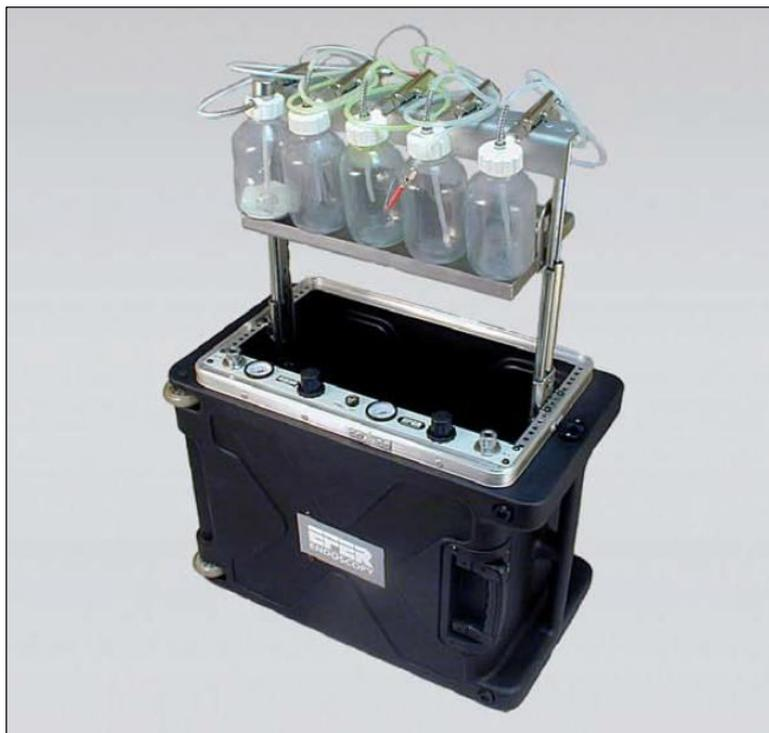
Компания EFER совместно со всемирно известным производителем турбореактивных двигателей – компанией Snecma (группа SAFRAN) разработала оригинальную портативную систему для эндоскопического капиллярного контроля лопаток недемонтированных двигателей, реализующую широко известные принципы люмконтроля.
